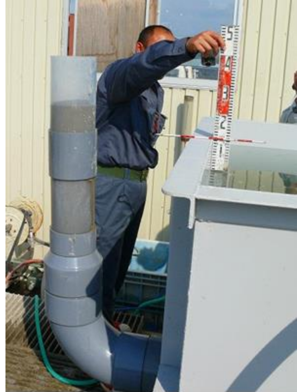
水槽水位面上部への充填材の押し上げ
