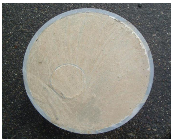
充填試験 注入管切断面
