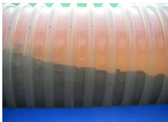
模擬施工での確認 満水状態の管内充填状況確認
