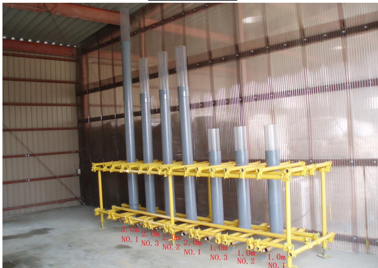
打設面変位測定装置
