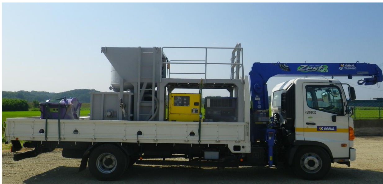
7t クレーン装置付きトラック搭載状況
