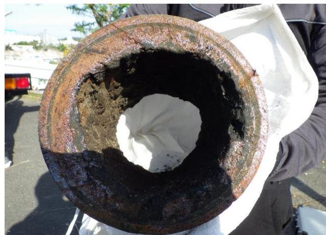
充填管切断面
