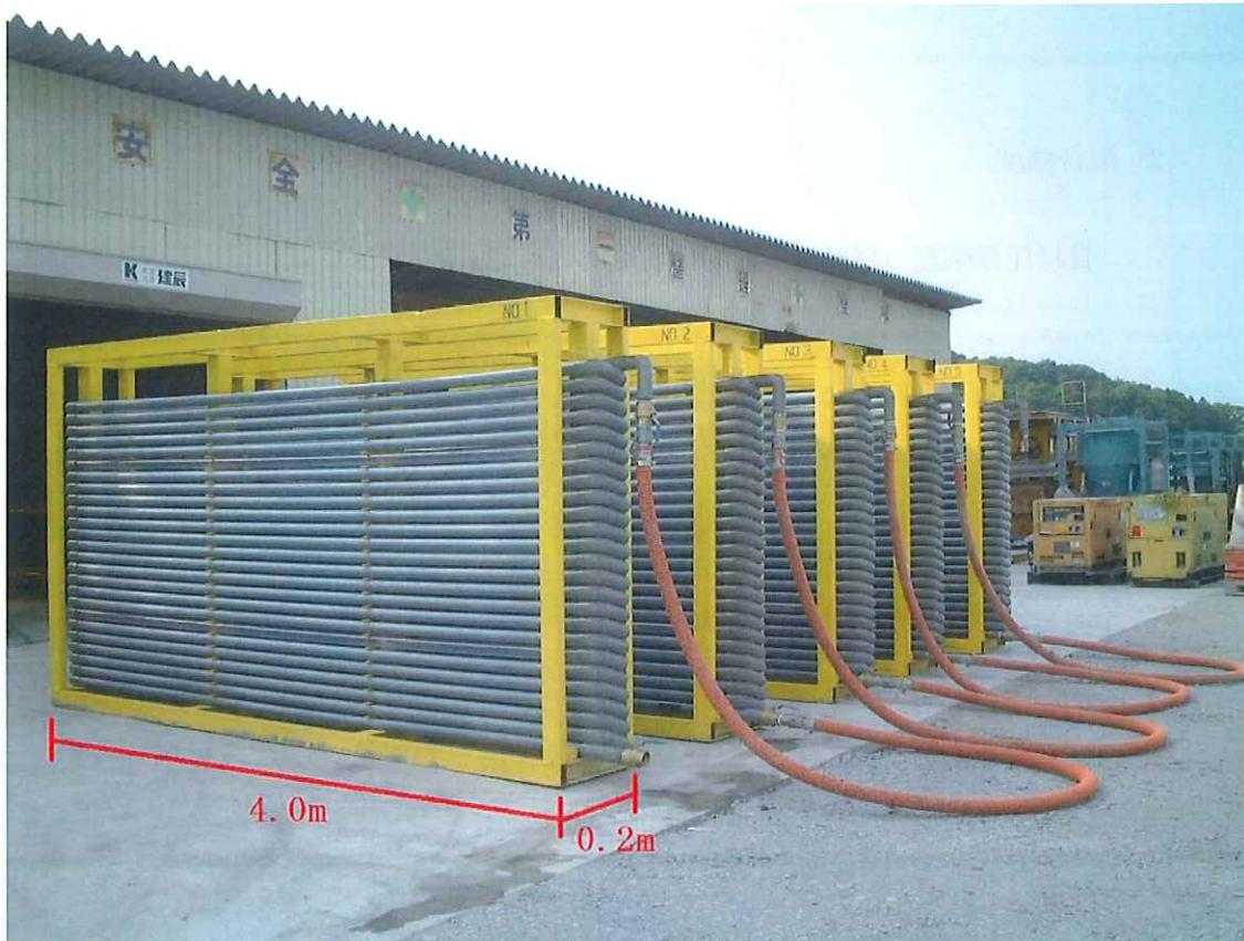
試験機 注入管 = VP  $\phi$  50mm 管全延長 L = 1050m
