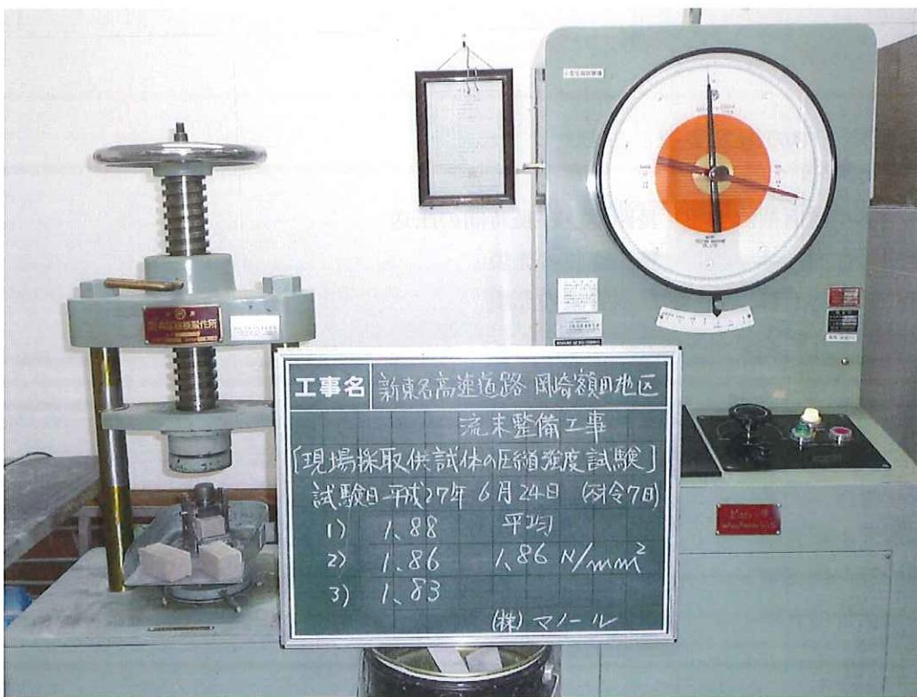
参考写真 小型強度試験機による圧縮強度試験
