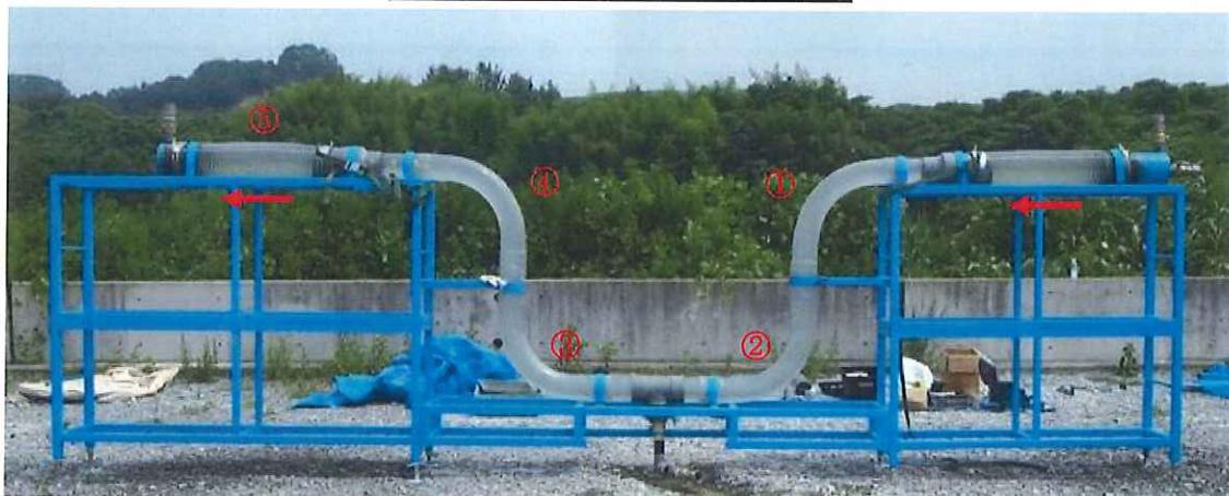
注入開始後、下り勾配になったセルクリートモルタルは滞留水と接した断面に渦水の発生や材料分離が確認されず滞留水を押し出す様子が確認できた。
