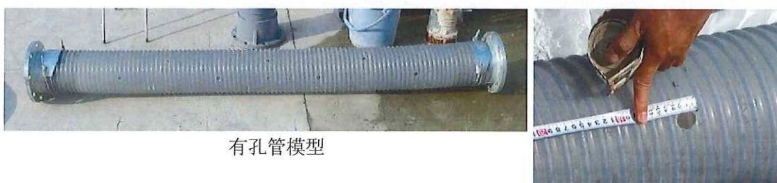
本実験により、有孔管に注入された充填材料は孔部より流出せず、管内充填が可能であることを目視確認することが出来た。
