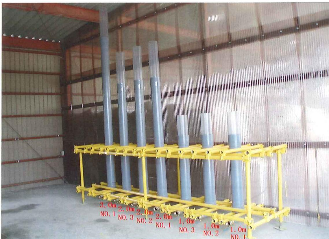
打設面沈下量測定結果
